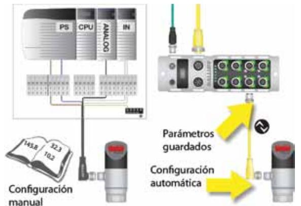
Figura 2. Configuración manual vs. automática
