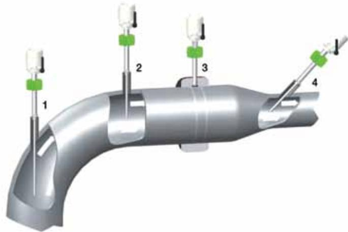
Imagen. Son posibles muchas opciones de instalación para integrar el sensor de temperatura *Wireless Hart TSP300-W* con *Energy Harvester* en un proceso. 1) Inserción recta en el codo de una tubería. 2) Inserción recta en la sección recta de la tubería. 3) Instalación en la tubería a través de la opción de montaje de superficie. 4) Inserción en la tubería con cierto ángulo.
