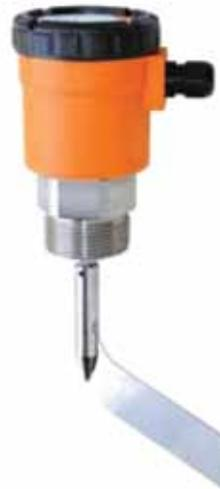
producto alcanza al cono, este se desplaza lateralmente inclinando la varilla. Un pivote situado en el cabezal y solidario a la varilla transforma este movimiento lateral en un movimiento vertical actuando el microinterruptor que se encuentra en el interior del cabezal. Es muy importante el lugar de montaje para aprovechar el talud que se forma cuando se llena el silo. Se trata de un nivel que puede resultar económico.
