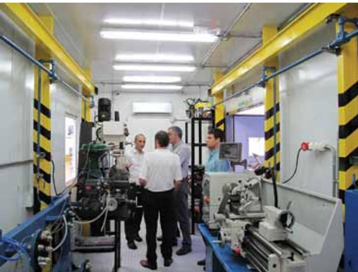
Su completo equipamiento a bordo permite la obtención de diagnósticos avanzados a través del software *AMS Suite: Intelligent Device Manager* con *ValveLink Snap-On*, una herramienta *FlowScanner 6000*, un comunicador de campo *475 Field Communicator* y pruebas de fuga en asientos. Tiene capacidad para trabajar con válvulas de 0,5 a 12 pulgadas y disponibilidad permanente de
