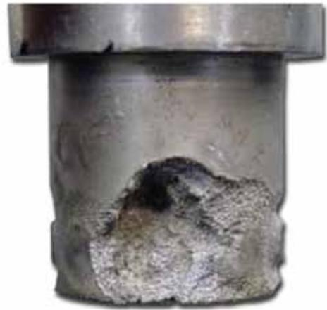
Figura 1. Un ejemplo del daño causado por cavitación
