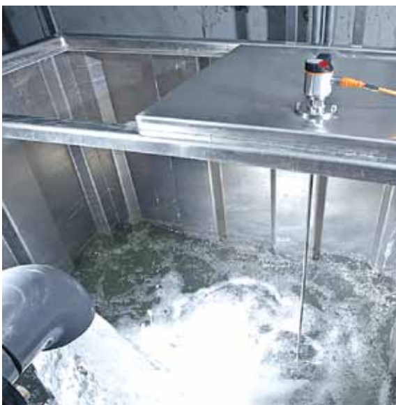
Los sensores de nivel LR de ifm electronic funcionan con ondas radas guiadas, evitando así mediciones erróneas causadas por residuos adheridos o formación de espuma.
