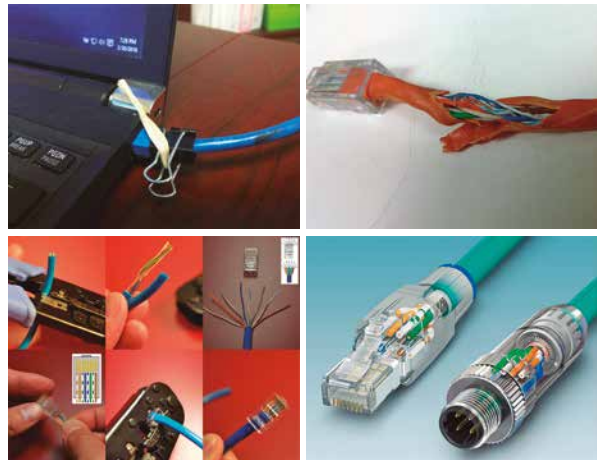
Figura 11. Conector RJ45 dañado; cable UTP dañado; armado de un conector RJ45, y conectores Ethernet para uso industrial
