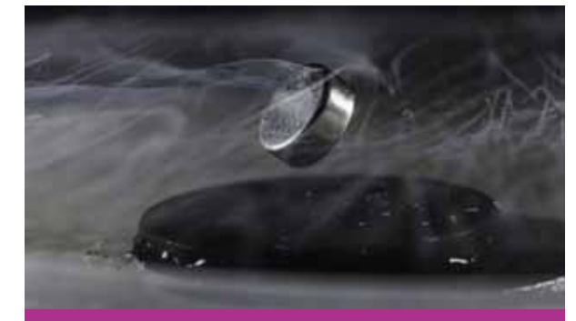
Un imán flota sobre un superconductor enfriado con nitrógeno líquido. Foto: Uni Rochester / J. Adam Fenster
