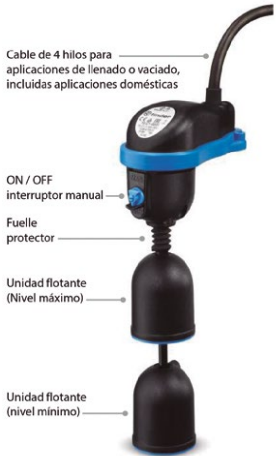
Figura 6. 72.C1, regulador de nivel por flotador para espacios reducidos
