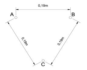
Figura 2. Posición de conductores en línea aérea compacta
