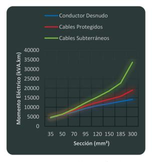
Figura 3. Momento eléctrico en función de sección del conductor
