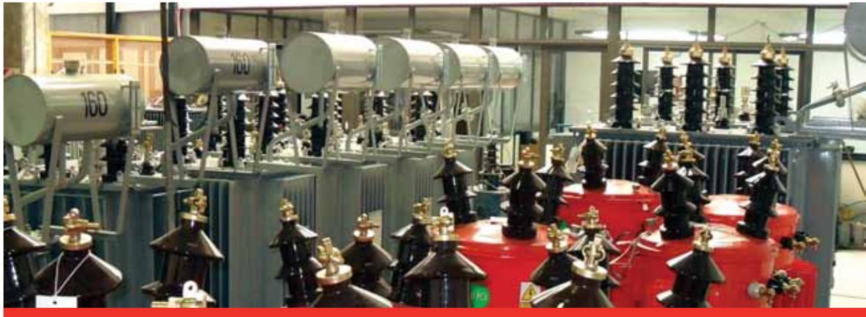
pueden ser transformadores herméticos para pozo, creadores de neutro, transformadores con aceite de alto punto de inflamación, transformadores elevadores, transformadores de subtransmisión monofásicos, transformadores rurales antihurto, y otros.
