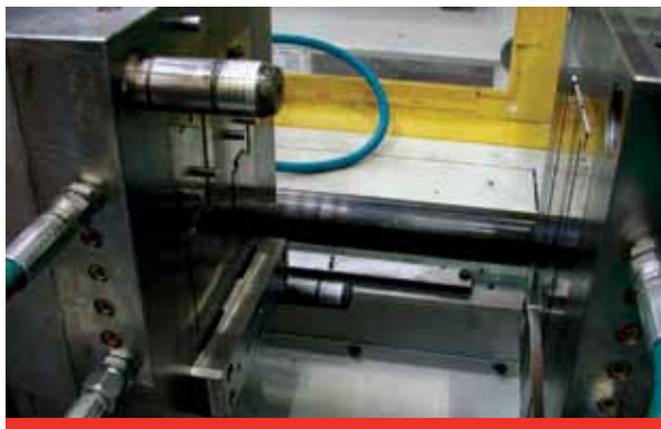
La herramienta de moldeo permite ajustar la longitud del espaciador radial de acuerdo con las especificaciones del cliente
