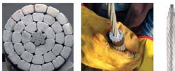
Figura 3. Un ACSS/TW. Se aprecia la semejanza visual con un ACSR
