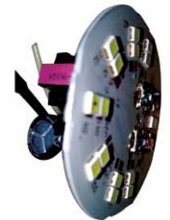
Detalle: frente (leds con sus resistencias limitadoras).
