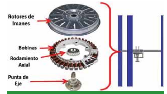
Figura 4. Esquema constructivo del generador eléctrico para el aerogenerador
