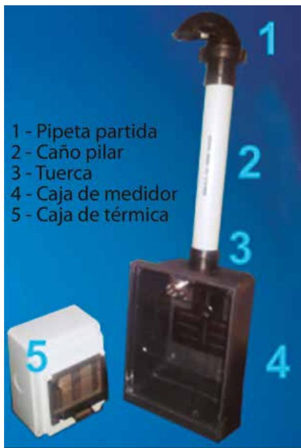
El caño, con diámetro exterior de 45 milímetros e interior de 36, soporta un tiro de 50 kilogramos en el punto de deformación permanente. ■
