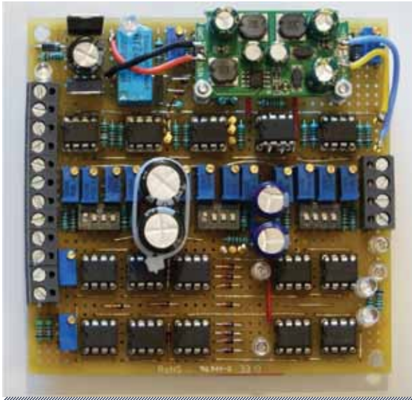
Figura 15. "Orgía" analógica. Este es el sobrenombre que se le dio a la nueva placa SSU que controla el posicionamiento del servomecanismo. Es tecnología clásica de inicios de los años '80, pero en la práctica se ha comportado muy eficientemente. Incluye quince amplificadores operacionales (CA-3140), tres DIP switches, cuatro interruptores analógicos SPDT (DG-419), dieciséis trimpots, un relay y el conjunto de fuentes \pm 12 y +5 V para referencias. La alimentación general es de 24 V.
