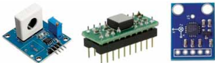
Figura 8. Algunos sensores del ecoPT. Izquierda: sensor de corriente por efecto Hall. Centro: giroscopio MEMS para corrección de virajes. Derecha: acelerómetro de triple eje, para detectar condiciones de impacto.
