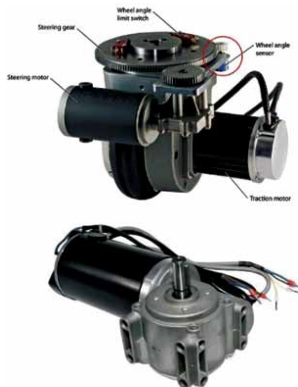
Figura 13. Dirección servoperada. Arriba: típica unidad de tracción y dirección como la que se emplea en algunos vehículos robóticos. El conjunto de la imagen pertenece a la empresa Allied Motion, de Estados Unidos. Abajo: motor seleccionado para el conjunto servoperado de dirección, que se utiliza normalmente en puertas operadas automáticamente.
