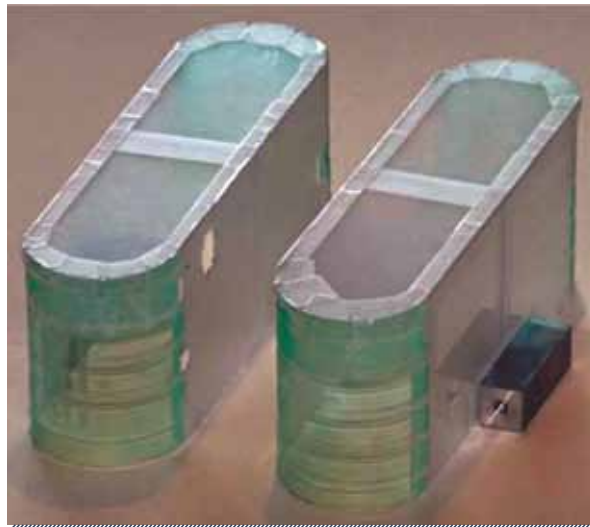
Figura 4. Artesanía. Estas son las piezas construidas para resolver los guardabarros del tándem de ruedas frontales, de construcción 100% artesanal. Además, estas partes hacen que el ecoPT se ubique en la cumbre de la protección medioambiental: las partes curvas están construidas con PET reciclado de botellas de agua mineral.
