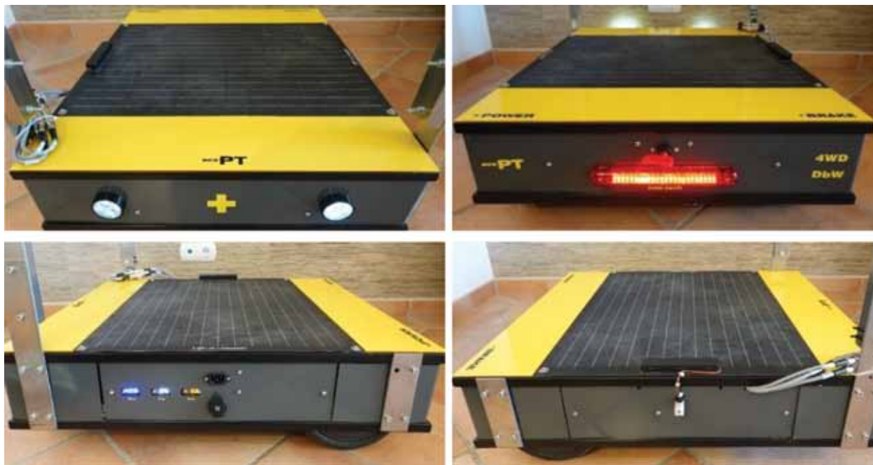
Figura 17. Vistas de los cuatro laterales. Imágenes del ecoPT según construcción. Las fotos superiores muestran los paneles frontal y trasero. La imagen inferior izquierda es del lateral que incluye las conexiones eléctricas para 220/240 Vca y para 12 Vcc (encendedor de automóvil). También se observan los voltímetros auxiliares para la medición de la tensión de baterías y de las tensiones de carga vinculadas con el panel solar o con la entrada auxiliar de 12 Vcc. La imagen inferior derecha muestra el lateral donde se conecta el panel solar mediante un conector DIN 43650 Tipo C.
