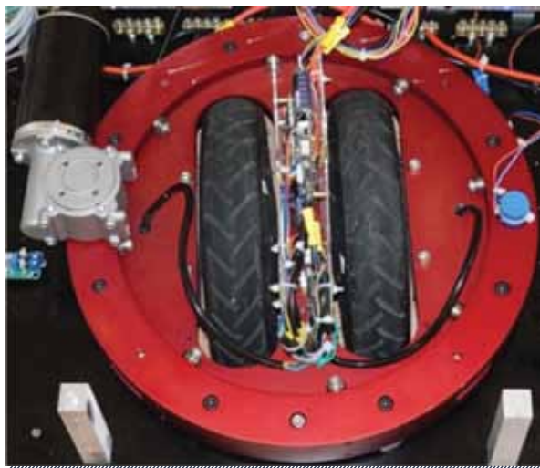
Figura 14. Conjunto de dirección electrónica servoperada. Vista del nuevo conjunto de dirección ya instalado en la plataforma inferior del ecoPT. En el centro se ubican los dos motores de tracción junto a la correspondiente electrónica de control. A la izquierda se observa el servomotor. La pieza azul que se aprecia a la derecha es el potenciómetro multivuelta para realimentación de posición.
