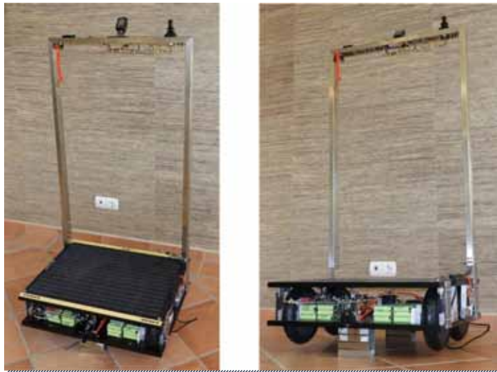
Figura 2. Montaje del ecoPT (primera versión). Izquierda: vista general de la construcción. El panel solar cumple un rol de alfombra en la plataforma que ocupa el conductor. Derecha: vista del espacio entre plataformas. Todos los elementos del tren de tracción, de la alimentación eléctrica y del sistema de control están montados en esta zona. Los cuatro packs de baterías se pueden ver en primer plano. Los suplementos de elevación son solo para los ensayos de rotación de las ruedas.
