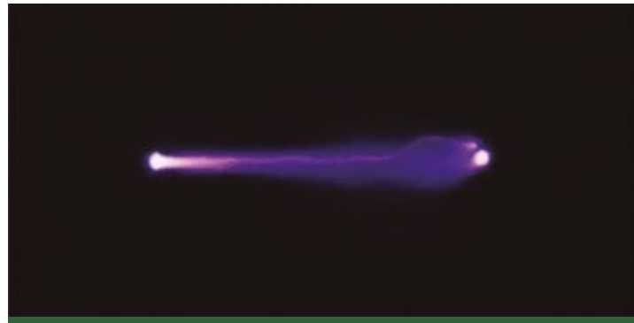
Figura 1. Trayectoria de una partícula de polvo. Fotografía de una descarga eléctrica realizada durante uno de los ensayos de la fuente de ocho etapas. El potencial aplicado es de, aproximadamente, treinta kilovolts con un resistor limitador de corriente de cien megaohms. Los electrodos tipo aguja están separados unos veinticinco milímetros y la nube de polvo se generó con talco de cosmética. El tiempo de exposición fue de un octavo de segundo en modo manual.
