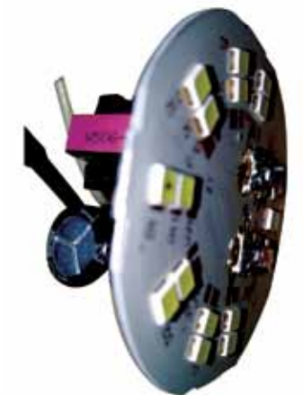
Detalle: frente (leds con sus resistencias limitadoras).
