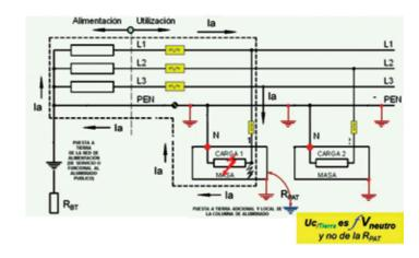
corriente de fase a masa, por contacto o baja aislación, similar a la de falla interna en el propio consumo. Se produce así la actuación efectiva de la protección local, por interruptor termomagnético o fusible, y desconecta rápidamente la alimentación.
