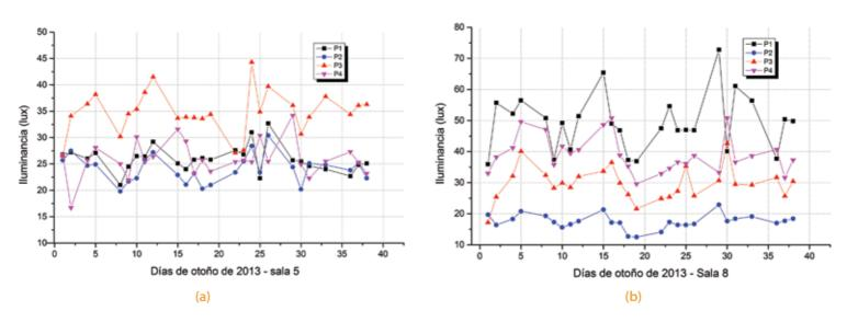
Figura 7. a) Variación de la iluminancia en cada punto de medición del fanal de imágenes de la sala 5 (a) y de la pintura al óleo de la sala 8 (b) en otoño 2013
