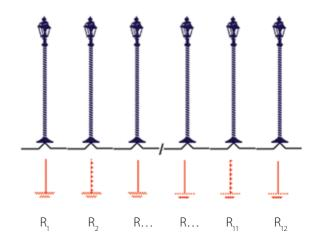
$R_1 = 73 \Omega / R_2 = 87 \Omega / R_3 = 102 \Omega / R_4 = 291 \Omega / R_5 = 276 \Omega R_6 =$  $247 \Omega / R_7 = 233 \Omega / R_8 = 218 \Omega / R_9 = 204 \Omega R_{10} = 189 \Omega / R_{11} = 174 \Omega /$  $R_{12} = 160 \Omega$ . Se determina el valor mínimo.  $R_{min}$  de setenta y tres ohms  $(73 \Omega)$ . Se calcula la resistencia eléctrica de puesta a tierra total del neutro para  $V_{N/ta}$  menor o igual a cincuenta volts (50 V):
