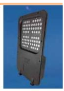
El proyector presenta con dos o cuatro módulos tipo FX115, con 36 o 72 leds en total. La potencia con dos módulos es de 83 W, con cuatro, de 143; la corriente, 0-600/0-700 mA, y el flujo luminoso, 6.921 o 13.842 lm. El equipo mide 575 mm de largo, 312 de ancho y 93 de alto y se monta con gancho trolley.
