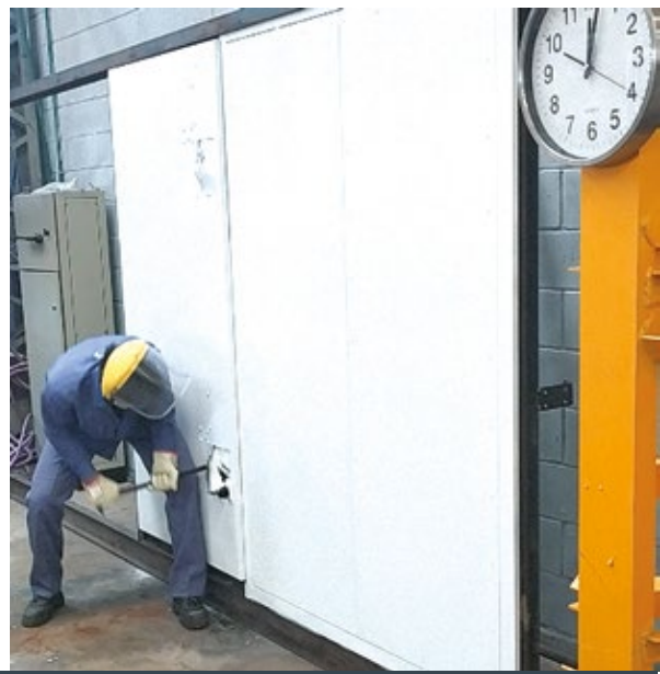
Figura 1. El ensayo balístico fue superado con éxito. Ninguno de los calibres y distancias probados logró atravesar el panel
