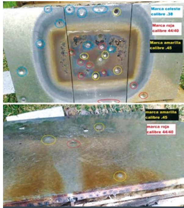
Figura 2 (video). El shelter es sometido a impactos de extrema dureza y los resiste exitosamente
