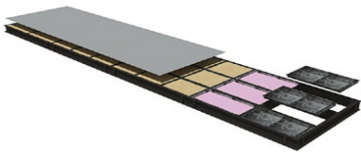
Figura 5. Bandejas de piso con aislación térmica
