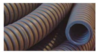
Elviplast Concret 75 son caños plásticos curvables autorrecuperables para canalizaciones eléctricas de hasta 1.000 V, para ser utilizados sobre tabiques, columnas o vigas construidos en hormigón, en construcciones premoldeadas, pretensadas y losas.
