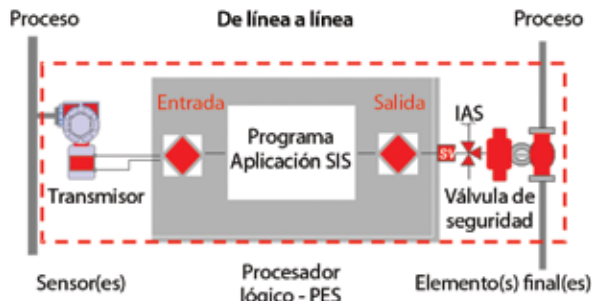
Figura 1. Definición de "sistema instrumentado de seguridad"
