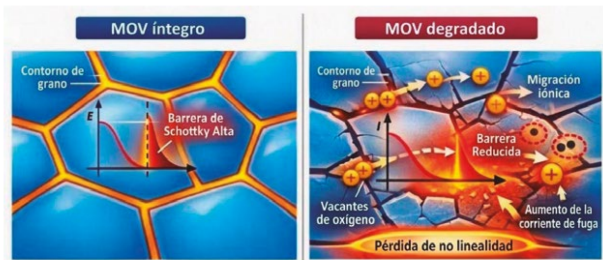
Figura 5. Estado del varistor
