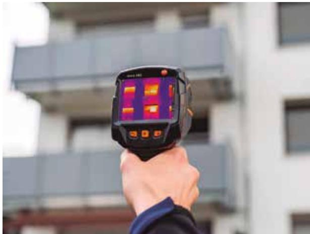
La cámara termográfica testo 883 se presenta como herramienta apropiada para las tareas de mantenimiento en general, sobre todo edilicio, eléctrico y mecánico.
