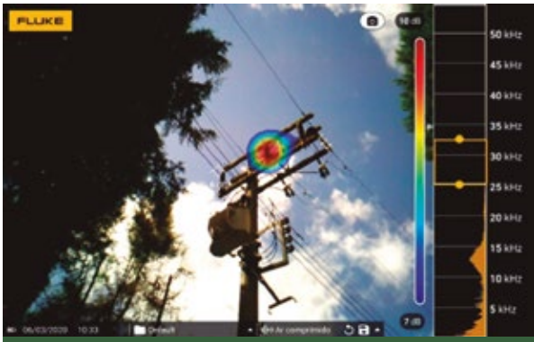
Figura 2. Imagen acústica de una descarga parcial superficial en un componente de media tensión
